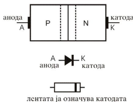
Слика 1.21: Структура, графички симбол и изглед на диодата.
