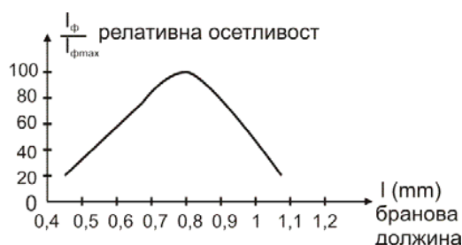
Слика 2.26: Карактеристика на релативна осетливост на фототранзистор.
