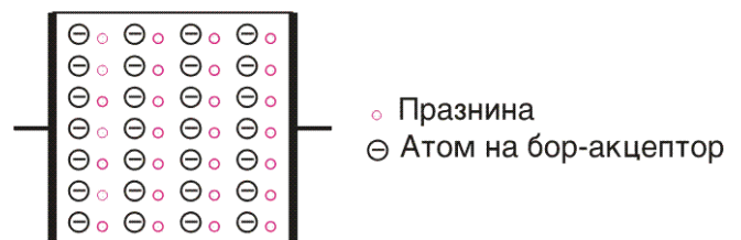
Слика 1.13: Шематски приказ на полупроводник од P-тип.
