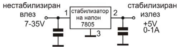
6.14: Приклучување на интегриран стабилизатор на напон.
